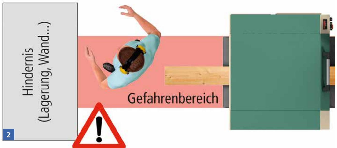
Bei langen Werkstücken dürfen im Ausschubbereich keine Quetsch- oder Scherstellen entstehen.
